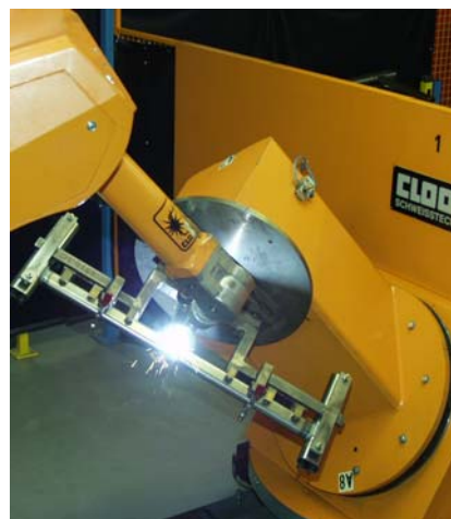
Ved pulver-plasma-svejsprocessen bliver metalpulveret overført via beskyttelsesgassen til plasmalysbuen.
