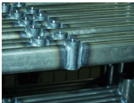
Svejsesømmene behøver ingen efterbearbejdning.
