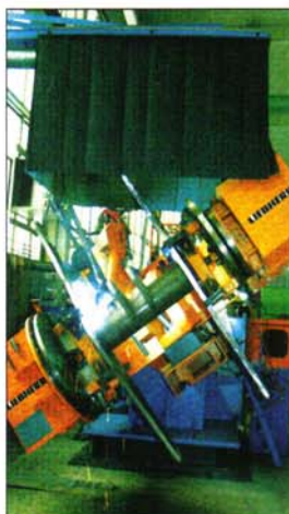
Manipulator med integreret svejserobot
